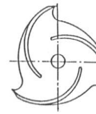
Bild 13: Offenes Dreikanalrad mit zylindrischen Schau- feln
