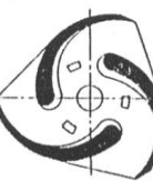
Bild 12: Geschlossenes Dreikanalrad (Draufsicht ohne Deckscheibe dargestellt)
