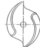
Bild 11: Offenes Zweikanalrad mit S-förmigen Schau- feln
