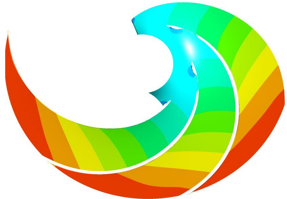
Statischer Druckaufbau in den Laufradkanälen
