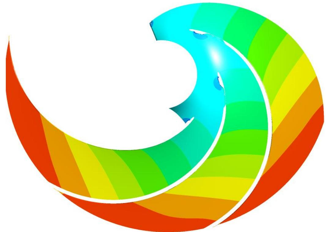
**Statischer Druckaufbau in den Laufradkanälen**
